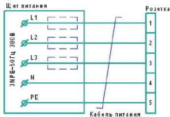
Рис. 3 Схема подключения розетки к стационарной сети
